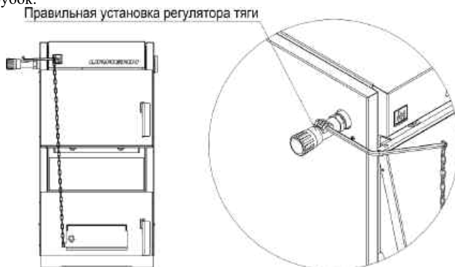
Рис. 10 Установка регулятора тяги
